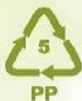
Используется для производства крышек от напитков, контейнеров для пищевых продуктов, многоразовой посуды, лотков в холодильниках, автомобильных бамперов и ковриков, шприцов, игрушек.
